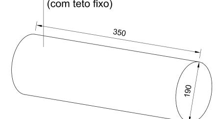
Capacidade do Tanque de Óleo Diesel 15.000 Litros ou 15,00 m<sup>3</sup>
